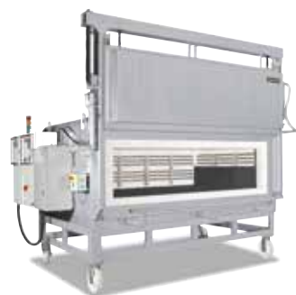
Horno de recocido con puerta de elevación electro-hidráulica y soporte inferior móvil para precalentar piezas grandes de chapa en la industria del automóvil véase página 50
