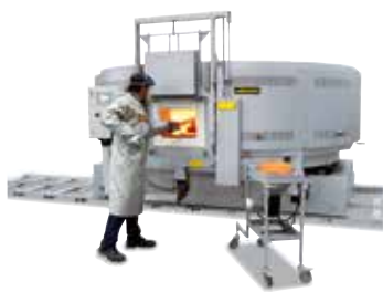
DH 2500/S sobre rieles para poder moverlo entre dos forjas
