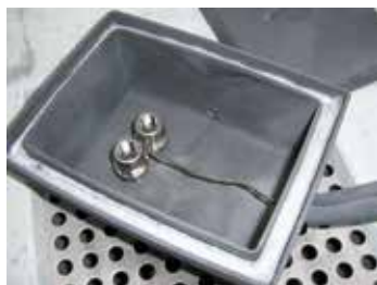
Soldadura fuerte en caja de recocido
