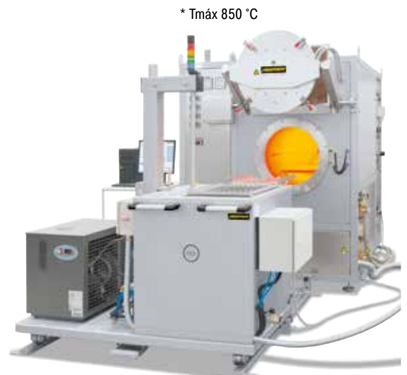
Equipo de revenido semiautomático con horno de retorta NR 50/11 y baño de enfriamiento por agua en un sistema de rieles
