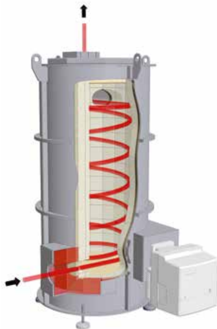
Representación esquemática de un sistema de postcombustión térmica (TNV)
