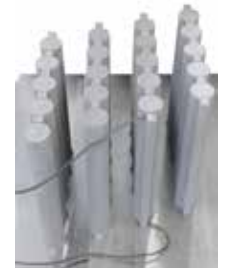
Barras de tracción de titanio después del tratamiento térmico en el modelo NR 50/11 en atmósfera de argón
