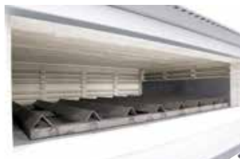
N 1760/S para precalentar chapas con superficie de carga
