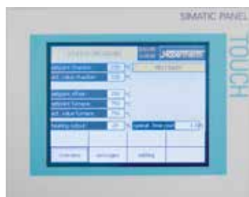
H 1700 con representación a color de los datos en forma de tabla
