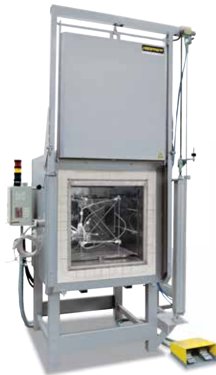
Estructura de medición para determinar la homogeneidad de la temperatura
