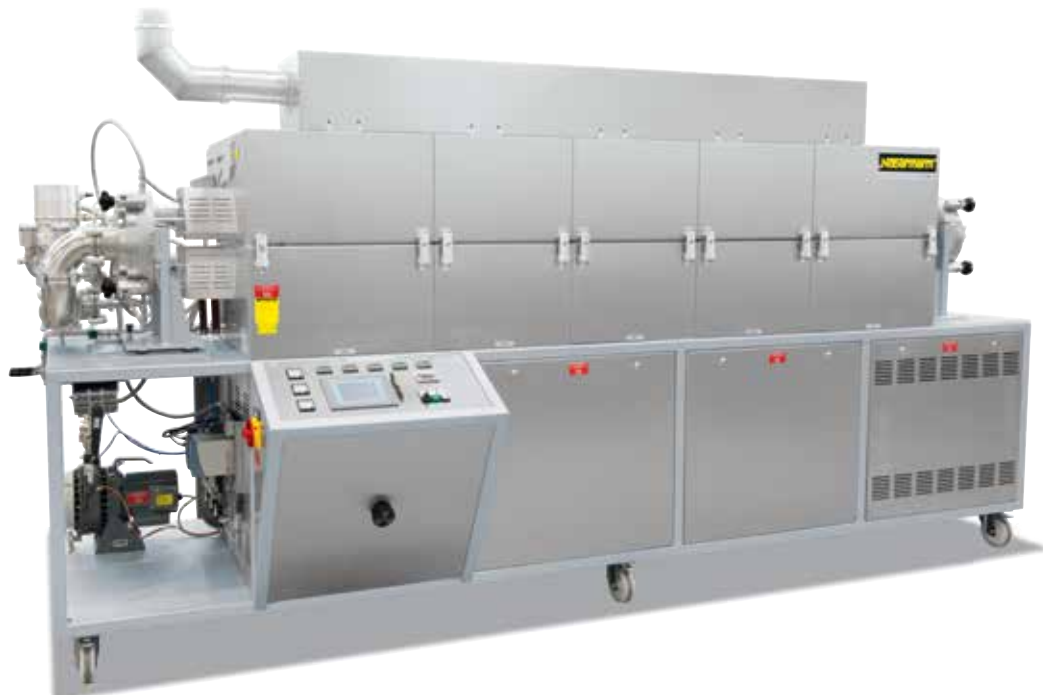
RS 250/2500/11S, control de cinco zonas, para el recocido de alambre en alto vacío o bajo gases de protección, incl. refrigeración forzada y campana extractora
