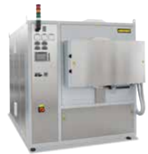
Horno con retorta NR 150/11 para el recocido para eliminar tensiones de piezas metálicas después de la impresión 3D
